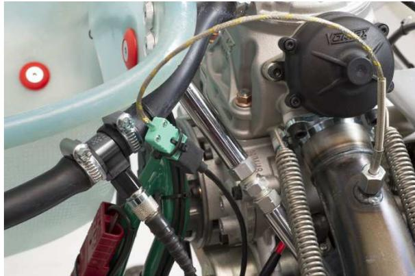
La calibrazione del sensore pedale si svolge in 5 passi (0%-25%-50%-75%-100% far riferimento al manuale DATAVIEW per maggiori dettagli). E' necessario fornire riferimenti precisi per ciascun passo di calibrazione.
