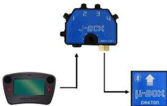
**Schema di collegamento per espandere un sistema formato da DASH e  $\mu$ -BOX con 4 ingressi aggiuntivi.**
