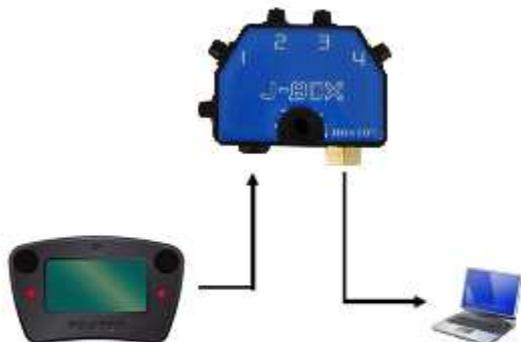
**Schema di collegamento per collegarsi a JBOX tramite un PC e procedere alla configurazione e calibrazione degli ingressi. Si deve utilizzare l'adattatore DAH-JBOX sul cavo USB.**
